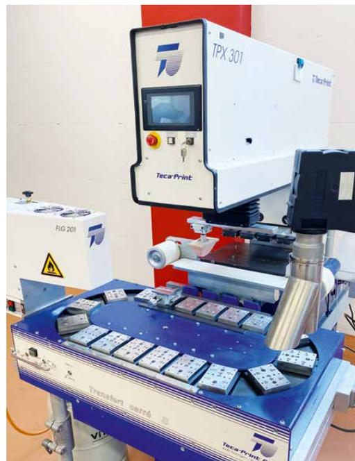
Die Plakette «ZÄME FÜR d'FASI» wurde mit 5 Farben im Tampondruckverfahren in der Prägetech AG bedruckt.
